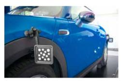
L'utilizzo dei bersagli opzionali per l'altezza scocca appositamente progettati consente di eliminare l'inserimento manuale dei dati. accelerare la misurazione e aumentare la precisione.
